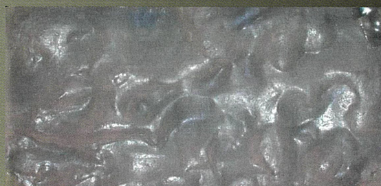
現場タイルを元に熱硬化ウレタン樹脂基板を作製
